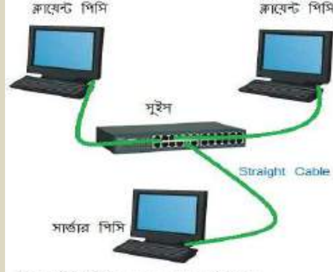
চিত্র ২.৭: তিনটি পিসির মধ্যে LAN Connection
