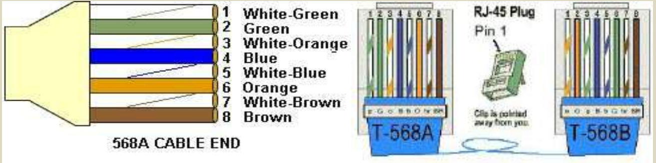
চিত্র ২.৫.২: Crossover Cable color code
